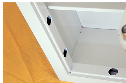
En el cuerpo, los bulones se alojan en unos refuerzos internos de 2 mm de espesor evitando una posible acción de palanca.
